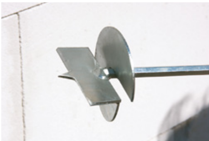
Na vytvoření kapsy použijeme plochý vrták.
